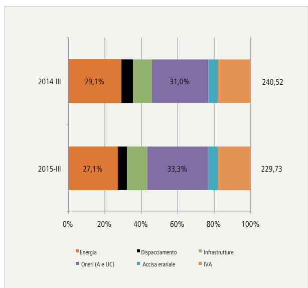
Fig. 3 – Confronto composizione media percentuale delle voci di spesa per la fornitura di energia elettrica del settore Terziario, regime di maggior tutela III trimestre 2015 - III trimestre 2014
